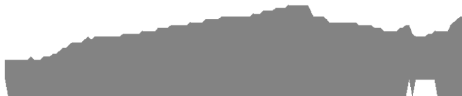
Figur 3. Profilbillede af en laksefisk (estimeret til 81 cm's længde), der passerede på et tidspunkt hvor nogle dioder var blokerede. Det er årsagen til, at bugen ikke er kommet med på billedet. Da længden skønnes ud fra den målte højde, var fisken sandsynligvis længere end de estimerede 81 cm.
